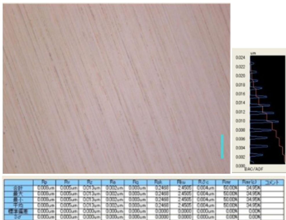
資料 2 . #8000 砥石研削仕上げ面 (2nmRa) (株)キーエンス レーザーマイクロスコープにて計測)
