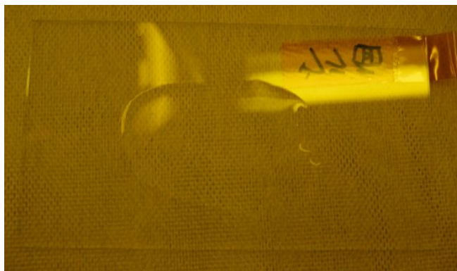
図 2-32 300 W で成膜された硬質ガラスの親水性表面
