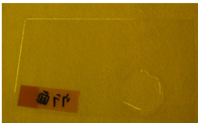
図 2-34 1000 W で成膜された硬質ガラスの親水性表面
