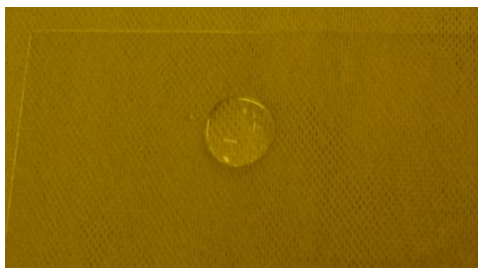
図 2-37 1000 W で成膜された硬質ガラス上のフッ化物系コーティング後の撥水性表面
