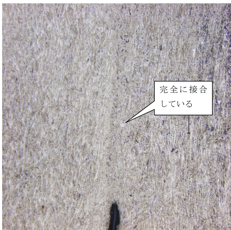
図 1 7 - 3 (中空+中空) 界面 (寄り代 4 + 4 = 8 mm) 内径側部位 50倍
