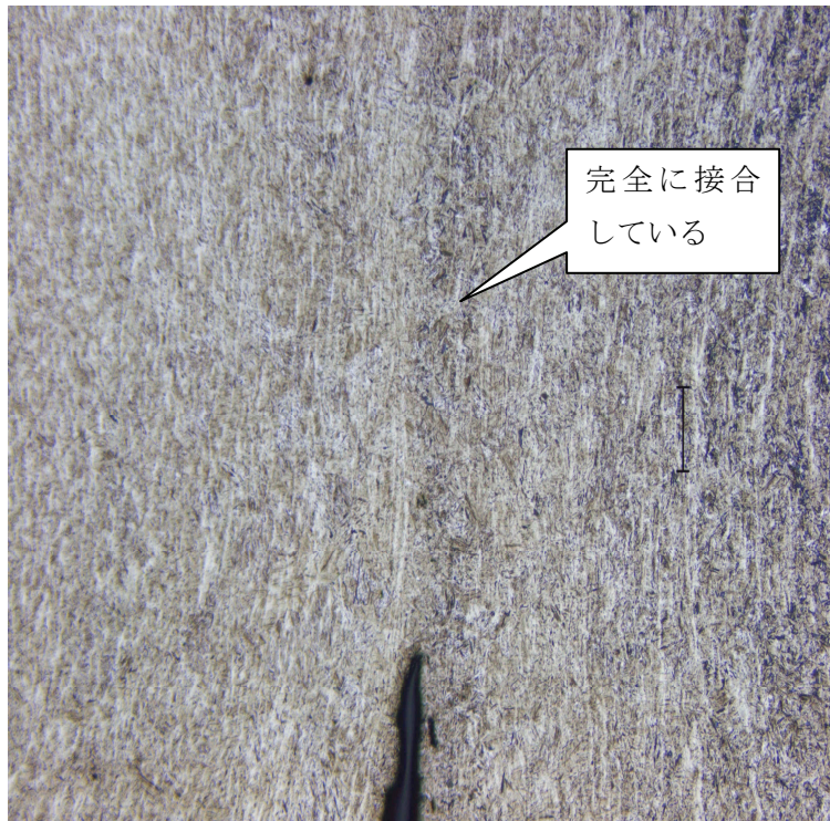
図 1 6 - 3 (中空+中空) 界面 (寄り代 3 + 3 = 6 mm) 内径側部位 50 倍
