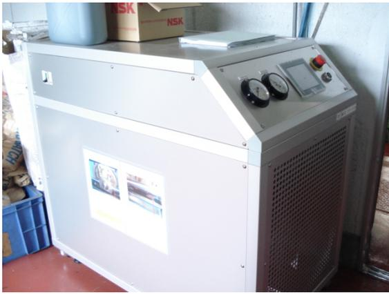
図3 窒素ガス発生装置本体
