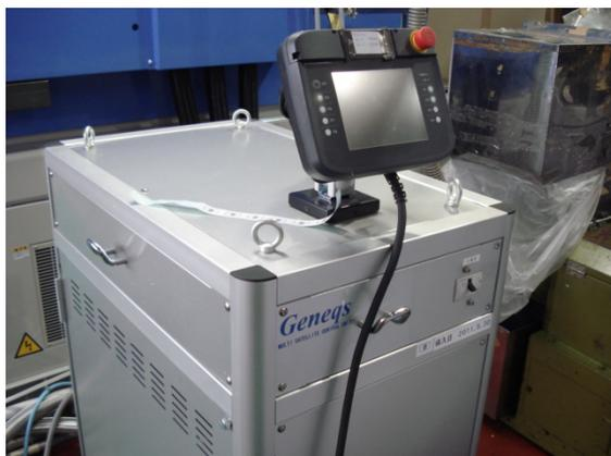
図1 ヒートアンドクール装置本体
