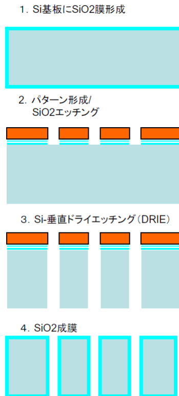
図37 Si貫通孔基板ウェハの製造工程
