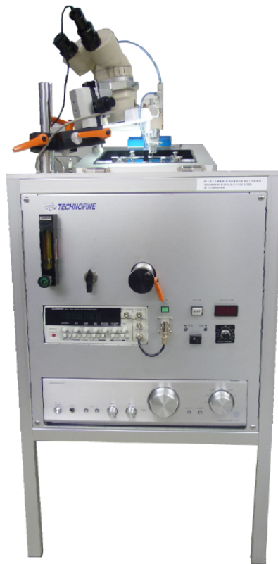
図21 金属ボール挿入実験装置改造の外観写真(全体)
