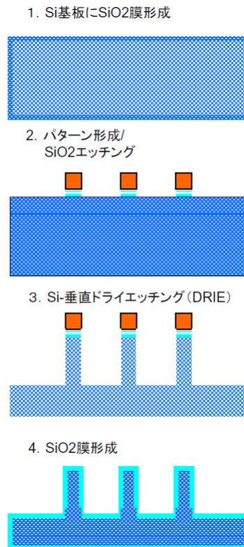
図34 Si加圧用ウェハの製造工程
