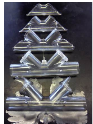
測定管一体化成型 (充填状況)
