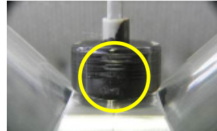
熱伝導性に優れた PC カバーの測定管一体化成形
