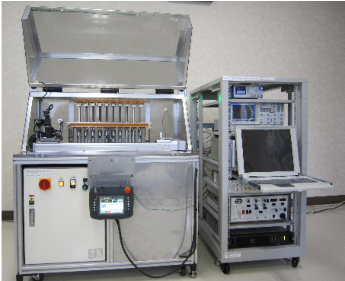
図2 実験用電界攪拌装置
