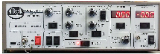
図 3-4 基準高圧電源装置 (Trek 製 615-3-S)
