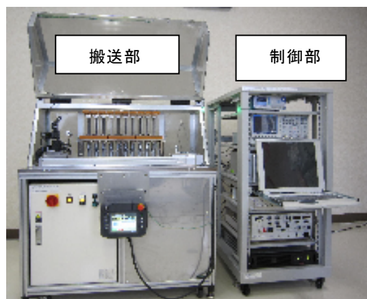
図 2-1 実験用電界攪拌装置(全体)
