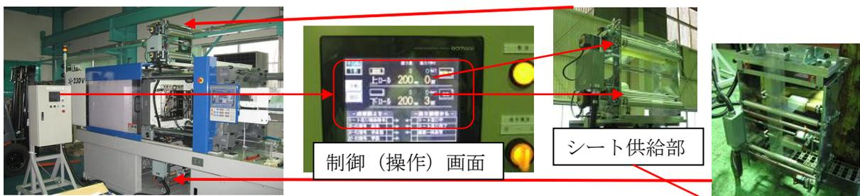
図 3-6 二層シート自動供給装置
