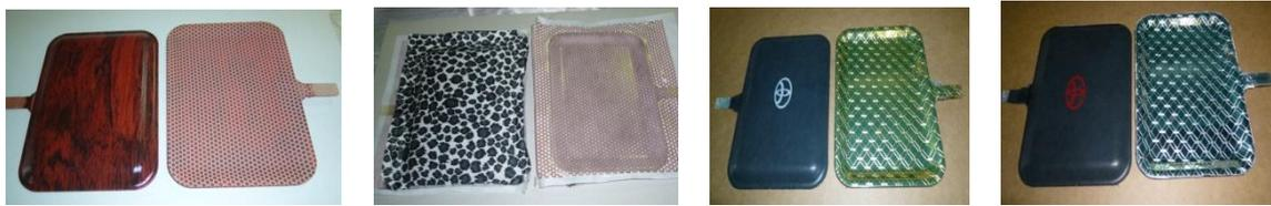
図 4-10 金属調・木目調・織物など加飾シートと機能シートでの両面加飾成形品
