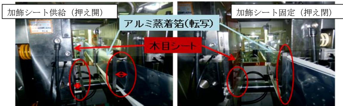
図 2-12 両面加飾シート金型構造と金型内実装
