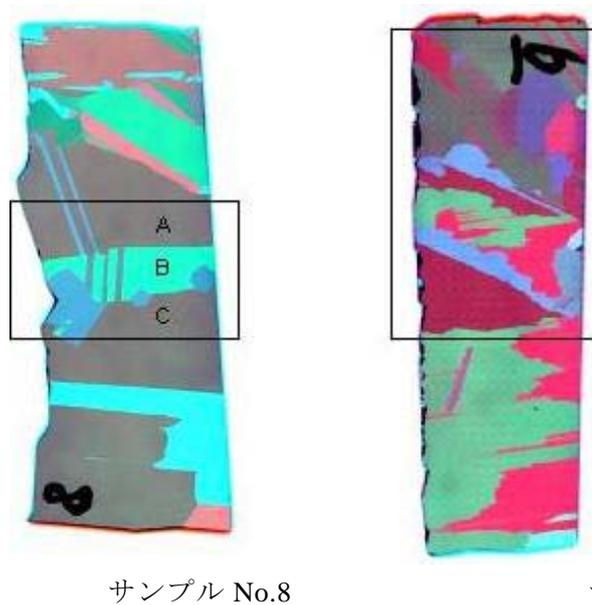
図 5-2 画像による方位識別（枠は EBSD 法による分析範囲）
