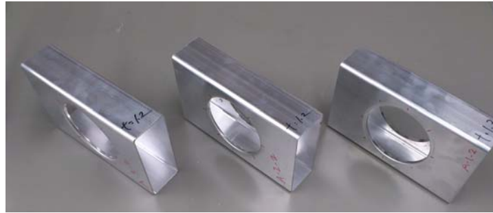
図 2-5 プレス成形加工品
