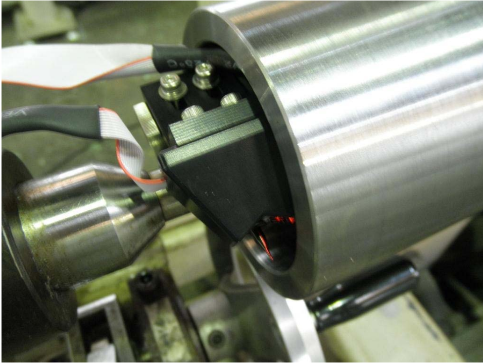
図 21 パイプ装入の写真(1)
