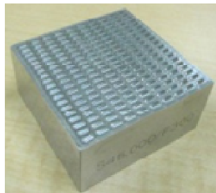
ELMAX 材(60HRC) 金型コア部 拡大写真
