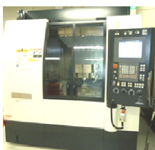
高精度マシニングセンタ iQ300 CAD/CAM FF/CAM(牧野) 切削液 オイルミスト(MQL)
