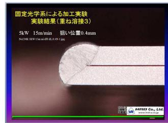
図 2-3-8 重ね合せ溶接断面写真
