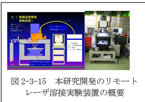
図 2-3-15 本研究開発のリモートレーザー溶接実験装置の概要
