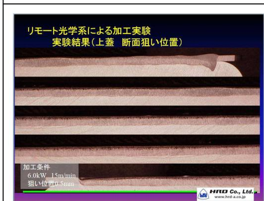
図 2-3-13 リモート溶接断面
