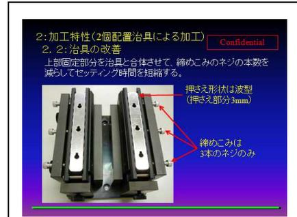
図 2-3-27 ワーク固定治具概
