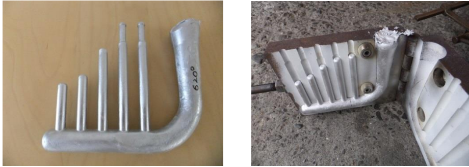
図 3-2-2-1 引張試験用テストピース（左：取り出したサンプル、右：金型に鑄込んだ状態、）
