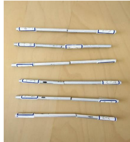
写真 5-3-1 引張り試験片（試験後） （写真の上から： AC4C, AC4CH, AC7A, ADC12, ADC10, 7075）
