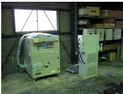
写真 4-1-1 電磁攪拌装置外観及び既存の 1 軸攪拌と 2 軸攪拌の原理比較
