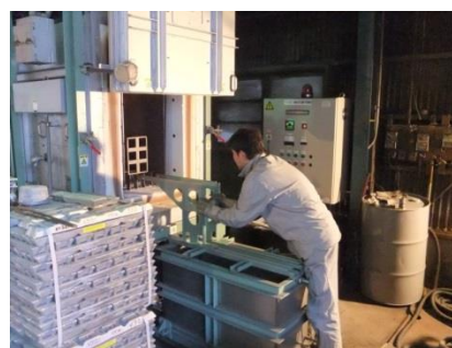
写真 5-1-2 T6 熱処理炉の使用状況
