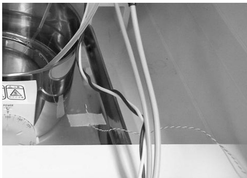
図 2-4.3 K 熱電対をオイルパンに設置した様子
