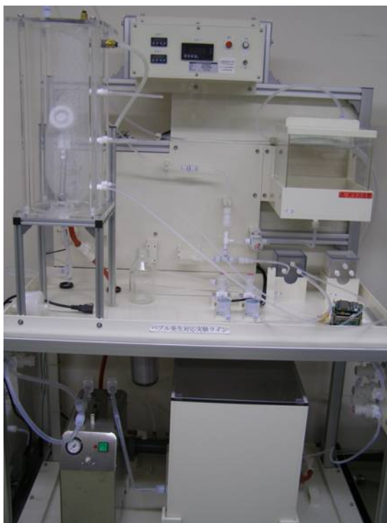
図 2-1.2 バブル発生対応ライン：改造後外観図
