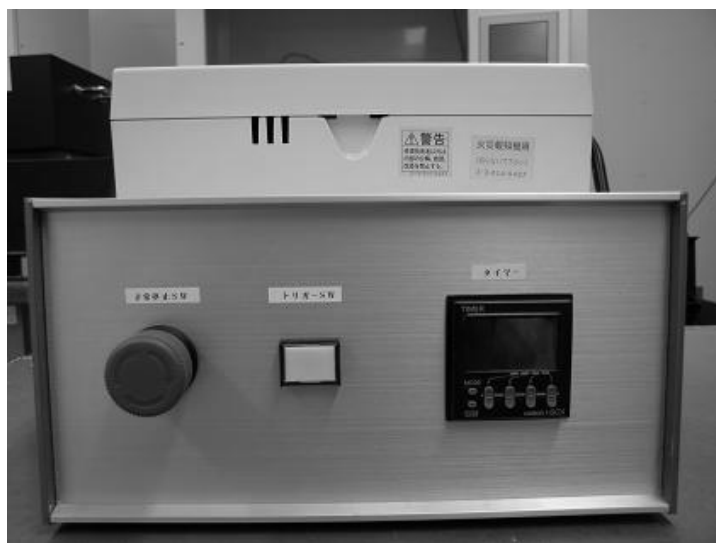
図 2-4.2 高温実験安全装置正面写真
