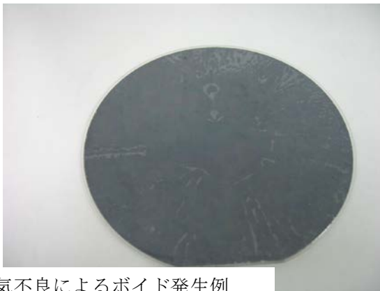
図 2-2-2 真空排気不良によるボイド発生例
