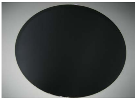
図 2-2-3 真空排気不良によるボイドなし例（真空排気 10Pa）
