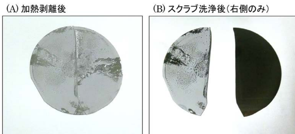
図 3-3-2 剥離した SiC 基板とスクラブ洗浄後の外観
