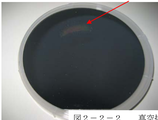
図 2-2-2 真空排気不良によるボイド発生例
