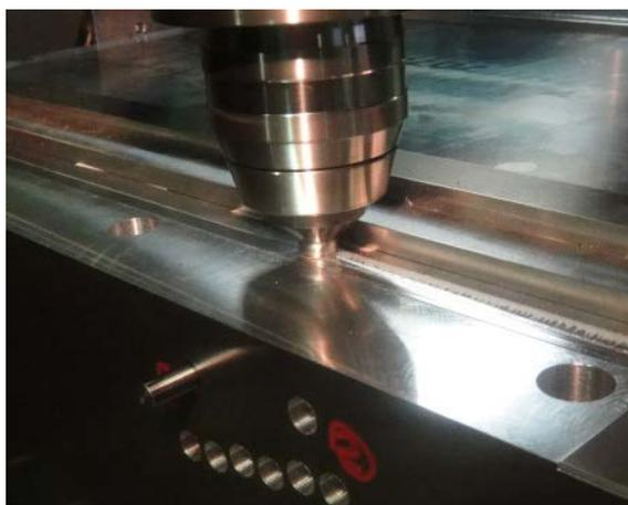
図2-9 リブと外板の突合せ接合試験状況
