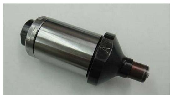
図2-7 片面摩擦攪拌接合ツール
