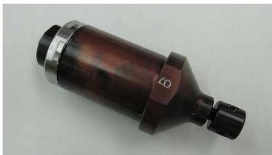
図2-6 両面摩擦攪拌接合ツール
