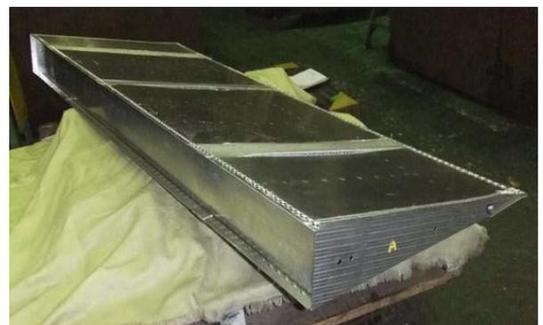
図2-15 摩擦攪拌接合で組立てた航空機のエルロン(完成品)
