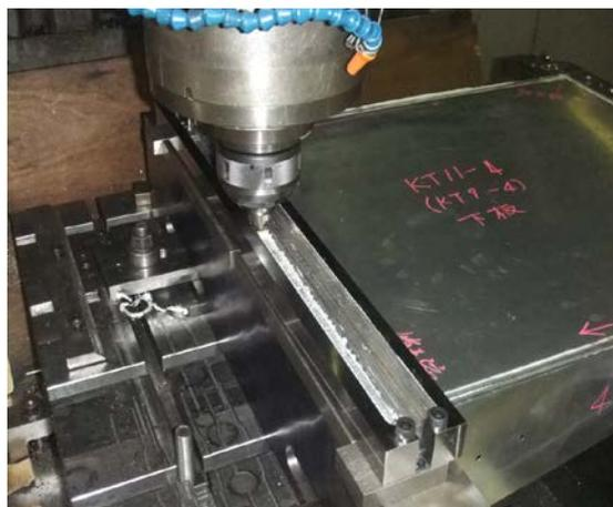
図2-10 前桁の重ね合せ接合試験状況
