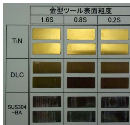
コーティング表面摺動試験結果（マイクロSCOPE観察）
