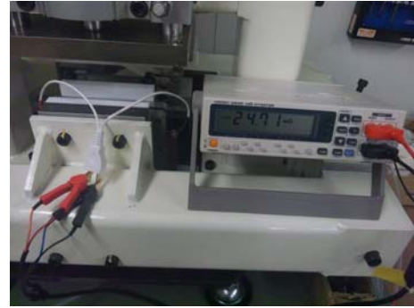
電気抵抗値測定（セパレーター測定時）
