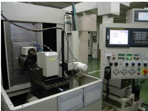
図 4.4 紫外光励起 PCD 研削盤
