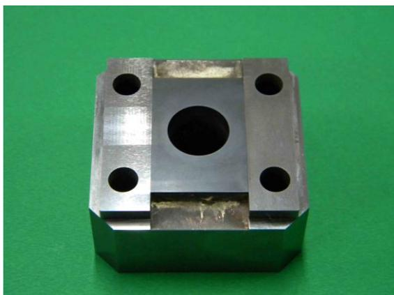
図 5.1 PCD 金型部品
