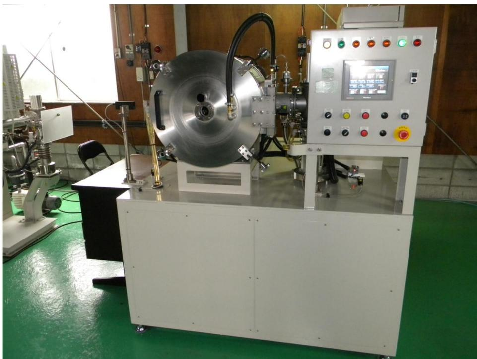
図 2.1 熱劣化レス PCD 接合装置
