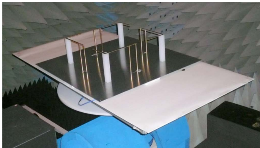
図 2-4-2-1-2 大地板に塩化ビニルシートを貼った様子
