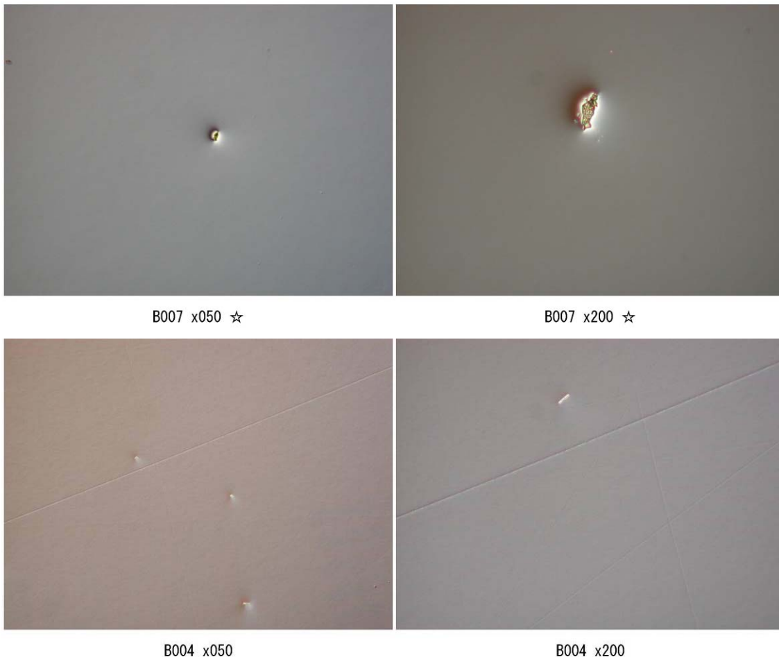
図 2-8 研磨表面形状のパッド依存性の例
