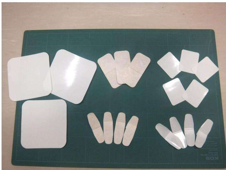
写真2 製品形状に打ち抜き加工した複合化フィルム
