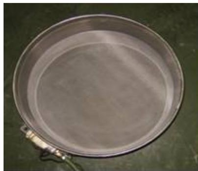
図 2-7. 試験用ふるい 開口 75μm メッシュ。
