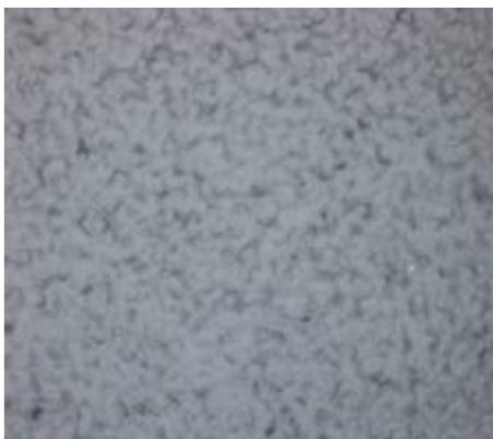
図 2-13. 改良ビーズで成型した試作品表面拡大図 600 倍。
