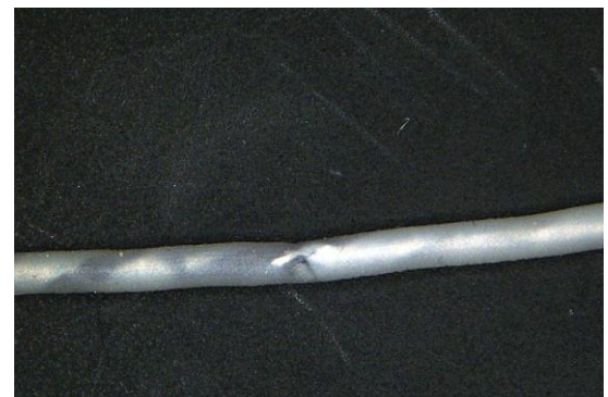
図3-3 防護樹脂塗工したRFIDファイバーの外観写真
