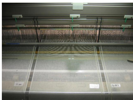
図 4-8 RFID ファイバーの製織状態
