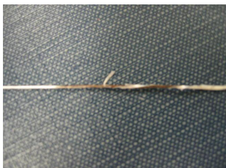
図 4-3 損傷した RFID ファイバー
