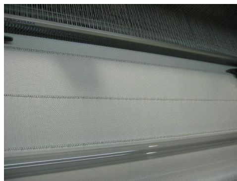
図 4-2 RFID ファイバーの製織
