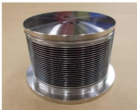
図 5.1.1 伸縮疲労試験用インコネル 625LCF 溶接ベローズ試作品
