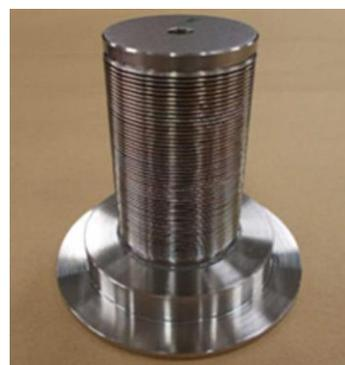
図 5.2.2 疲労試験用チタン製溶接ベローズ
