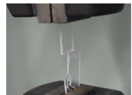
引張試験(接合部破壊)
