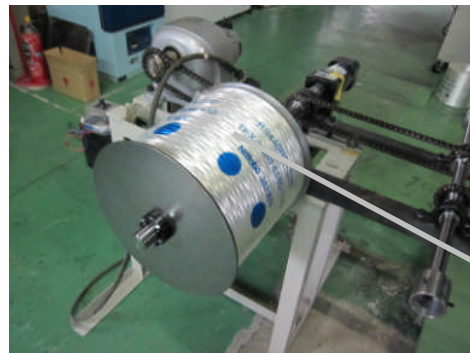
図 2.6 ロービング外側出し
