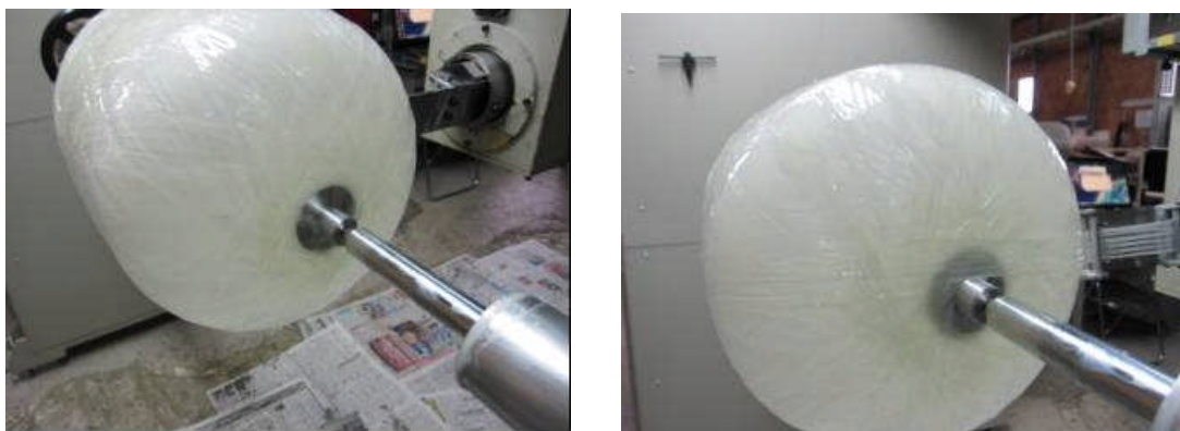
図 2.14 TYPE 4 本研究の最終形状の底金具。 \phi 55\text{ mm} でフランジ部厚さ 1.5\text{ mm} はライナーの外側に出ている。左図の様に先ずフランジの外径部を狙いFWを施す。その後右図の様にフランジ厚さ分をロービングで埋めてから金具を覆う。
