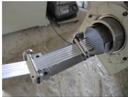
図 2.9 FW 設備ノズル部
