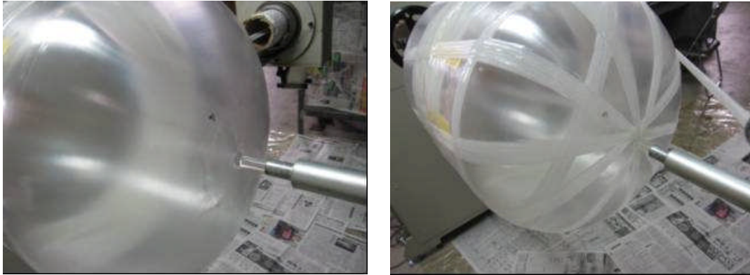
図 2.12 TYPE 2 底部に \phi 7\text{ mm} の軸を設けたタイプ
