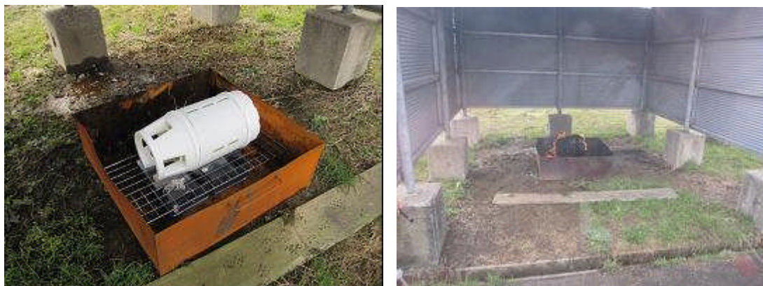
図 4.5 火炎曝露試験の様子
