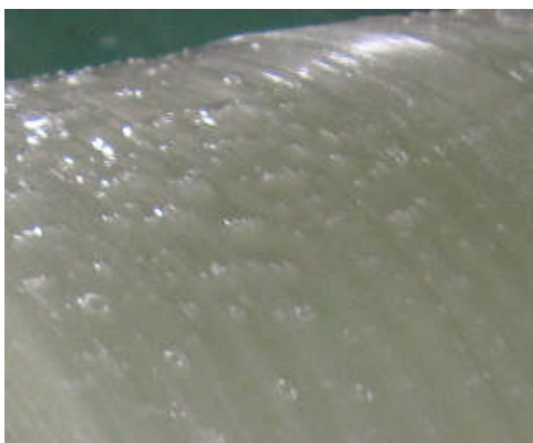
図 3.1 樹脂AのFRP化表面 表面に無数の気泡が発生している。
