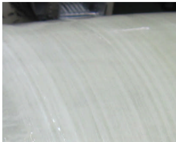
図 3.2 樹脂BのFRP化表面 樹脂配合検討後、気泡を除去された。
