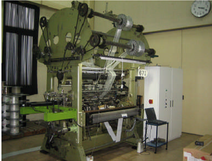
図 2.1 特殊装置を取り付けたダブルラッセル編機
