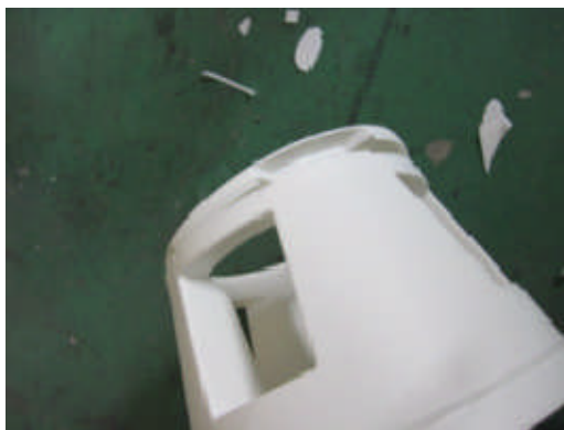
図 4.11 プロテクター上部破損
