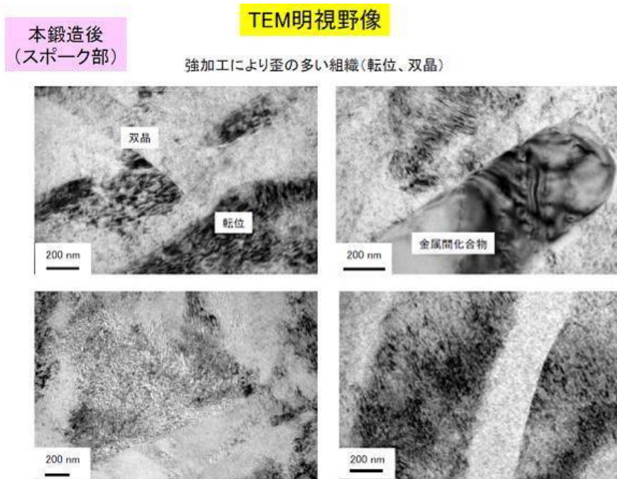
図-6 TEMによるナノレベルの結晶状態の測定図
