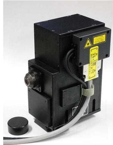
図 17 レーザプローブ測定器
