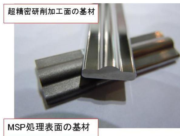
図 14 MSP 処理後と研削加工後の基材 2 の写真
