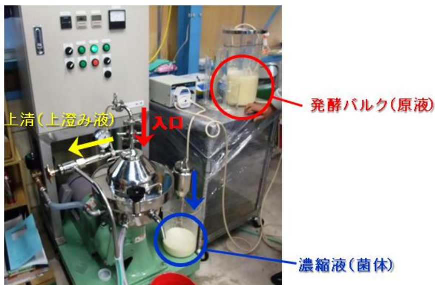
(図12)分離板型遠心分離機による連続遠心分離
