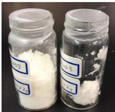
【図 2-2-2-2】 光重合性基化合物で修飾された窒素誘導体化合物の合成品
