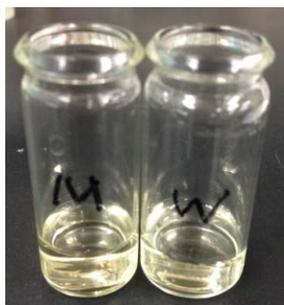
【図2-1-1-5】 窒素誘導体を開始剤とする重合によって得られた高分子のメタノール溶液（左）と水溶液（右）（ともに30wt%）
