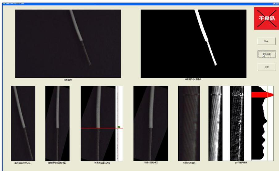
図 2-2-：電線被覆剥ぎ画像の良否判定デモアプリケーション
