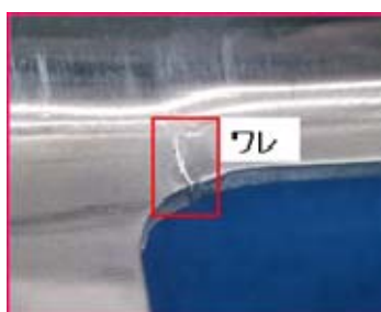
図9 対象部品1における複層鋼板成形上で発生したワレ
