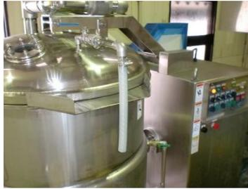
図 10 発酵菌添加装置付真空斜軸ニーダー
