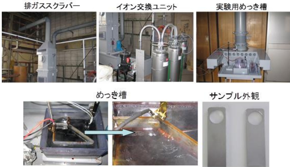
図 1-4 めっき研究設備外観、めっき槽部分およびテストピースめっきサンプル外観
