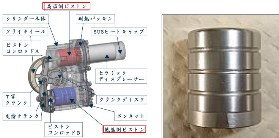
図 3-14 スターリングエンジン構造およびピストン外観 (ND 複合 Ni めっき)
