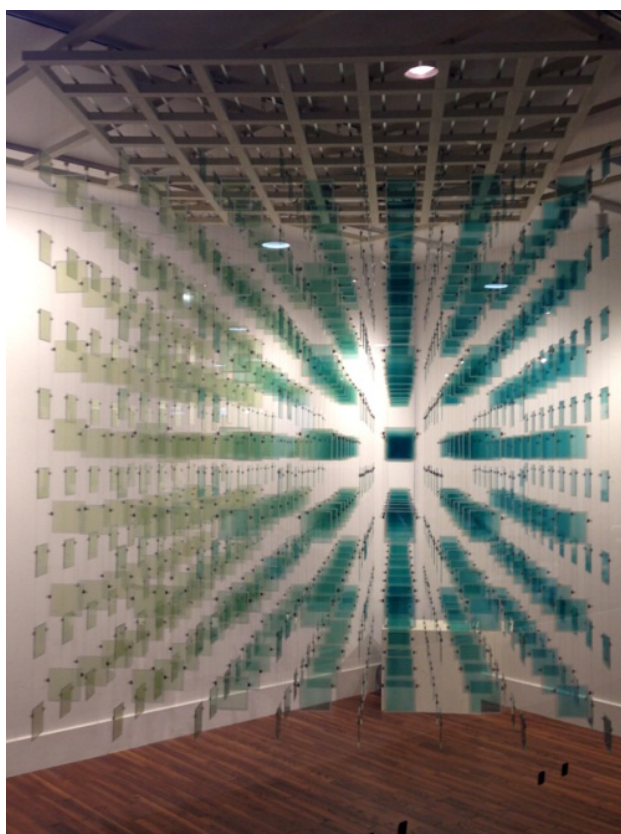
図 2－6 約 1 0 0 0 個の E C D を強調動作させた 3 次元ディスプレイ
