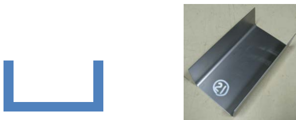
図 2.1.3 曲げ成形実験のための成形品形状
