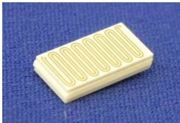
図 2-3.7 試作した LTCC 基板固定遅延線
