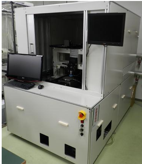
図 2 1 シリコンウエハスライス用レーザー加工試験試作装置の外観写真。
