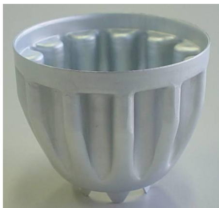
図 1-8 提案する製品 1-2 (H1000-1) の成形結果 (製品)
