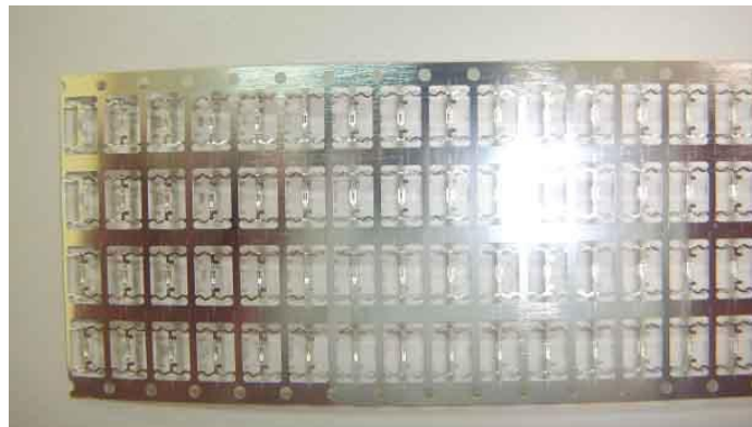
図 3-3 提案する製品（単色反射板一体リードフレーム）の成形品
