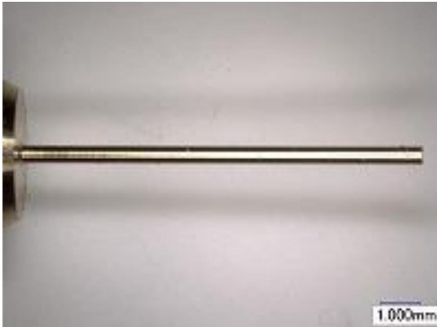
補正制御技術にて加工された C3604 サンプル
