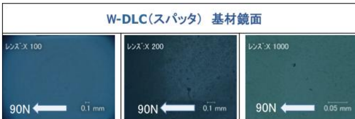
図 2.2.8 W-DLC のスクラッチ試験結果
