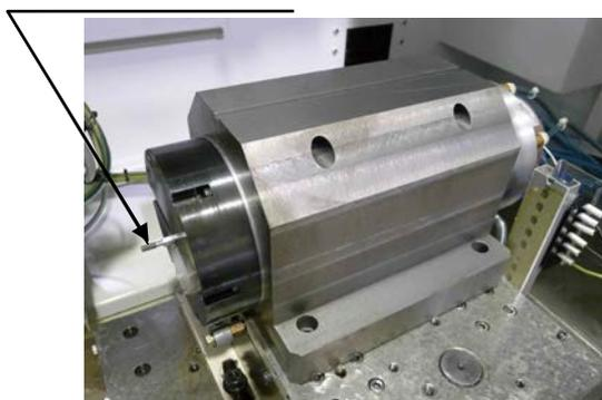
図 2.1.30 内面研削用超音波スピンドル外観
