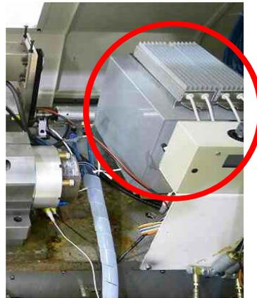
図 2.2.4 スwitchング装置プロトタイプ 図 2.2.5 完成した電解研削用電源(赤丸内)
