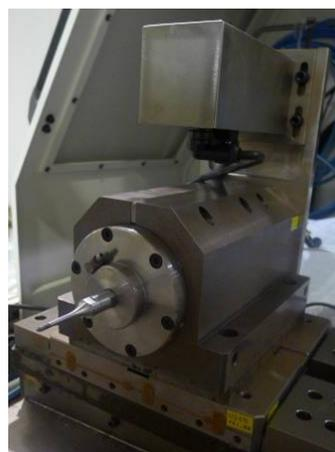
図 2.2.21 クーラントスルー型超音波電解スピンドル
