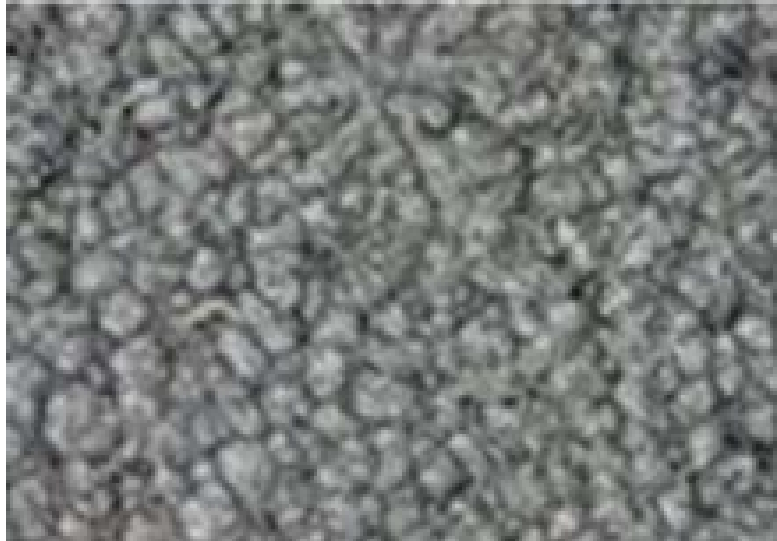
写真 2-2-1 AC4CH 半凝固スラリーの金属組織
