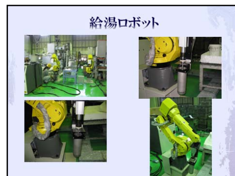
写真 2-4-3 自動給湯スラリー生成装置
