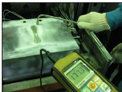
写真 2-3-2 プレス金型温度データ
