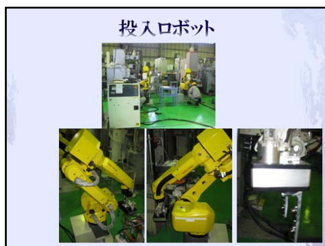
写真 2-4-2 自動投入装置
