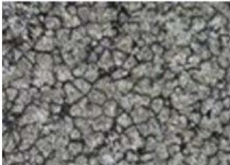
写真 2-2-2 6063 合金半凝固スラリーの金属組織
