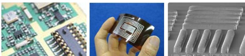
図1. 左から、プリント基板配線、フレキシブル基板配線、配線の顕微鏡写真
