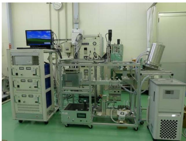
図5. 試作した液中蒸発法のナノ粒子製造装置（プロトタイプ機）
