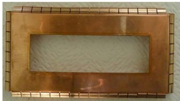
図21. 試作したアイリス板
