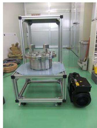
図10. 試作したセミフロー型フィルタシステム
