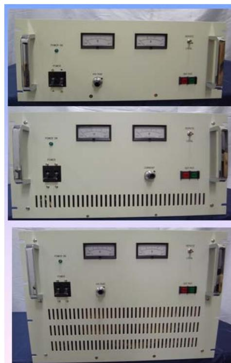
図18. 試作したマイクロ波電源
