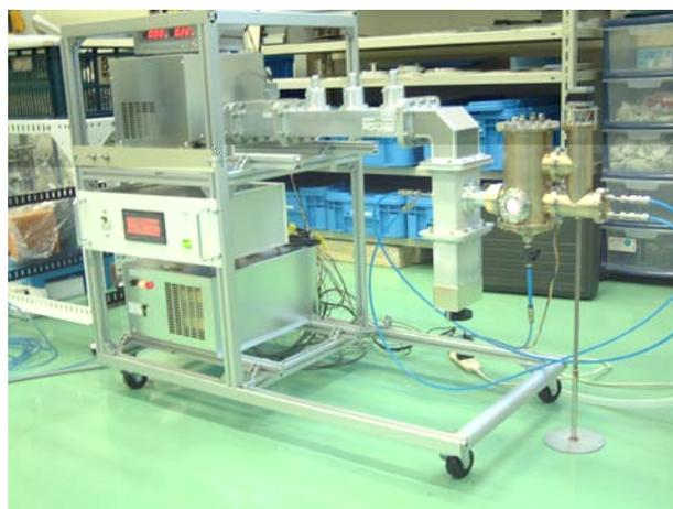
図4. 試作した化合物還元法のナノ粒子製造装置
