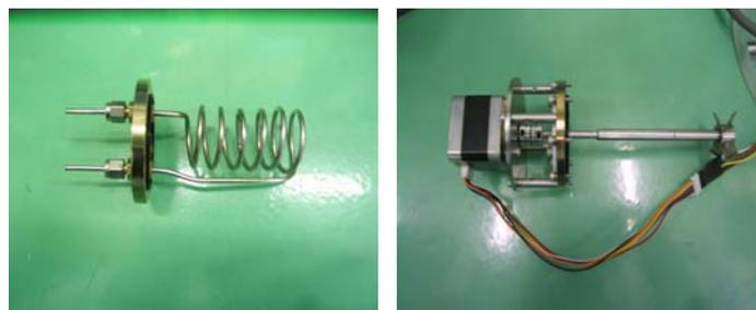
図8. 左は冷却キャピラリ、右は攪拌用プロペラ
