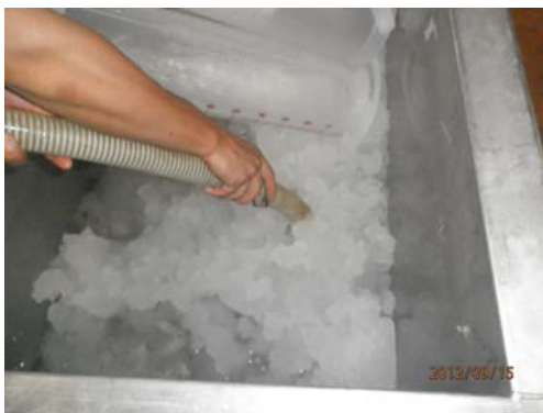
写真3. ①.1 タンクからシャーベット氷吸引試験
