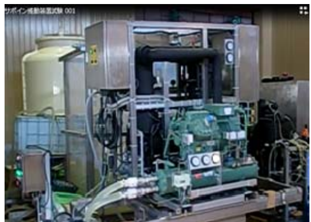
図 3. ②. 5 実用漁船搭載模擬装置による性能、耐久試験
