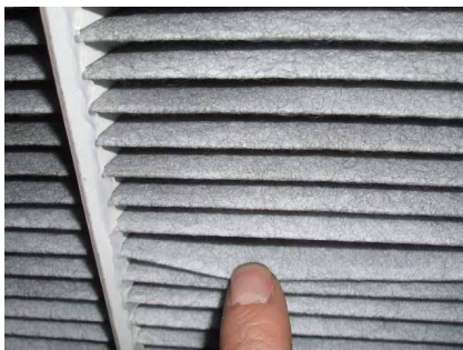
図 35 バインダー噴霧後抗菌散布による抗菌剤固着状態
