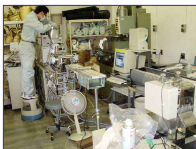
図19 マスターバッチ成形装置 二軸押出機(Brabender社製DSE 20)
