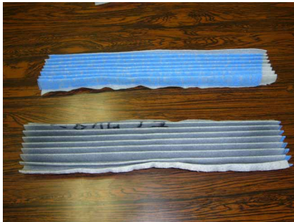
図 33 PPフィルター 抗菌剤をアクリルバインダーで固着後に畑野産業がフィルター仕様用にプリーツ加工して性能には問題はないとの評価があった。（裏面と表面の状態）
