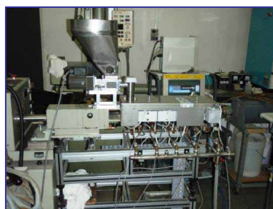
図19 マスターバッチ成形装置 二軸押出機(Brabender社製DSE 20)
