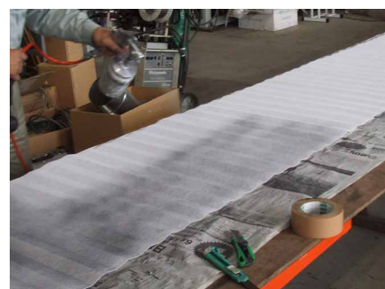
図 30 抗菌剤+バインダー混合噴霧試験
