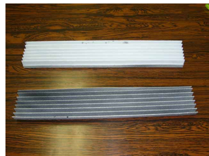
図 34 PEフィルタ 抗菌剤をアクリルバインダーで固着後に畑野産業がフィルター仕様用にプリーツ加工して性能には問題はないとの評価があった。（裏面と表面の状態）
