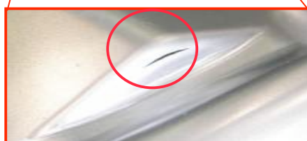
図 2 - 3 われ・しわの不具合がある成形パネル (a)実物 (b)デジタルデータ
