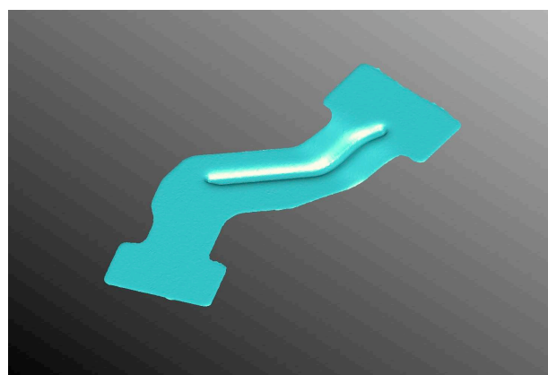
図4-2 寸法精度不具合対策前のデジタル化された不具合成形パネル
