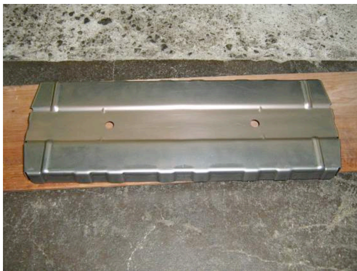
図 3-1 外形抜き、曲げ加工を行った成形パネル
