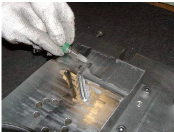
図 4-4 職人による手修正 (左 : 上型修正、右 : 下型修正)
