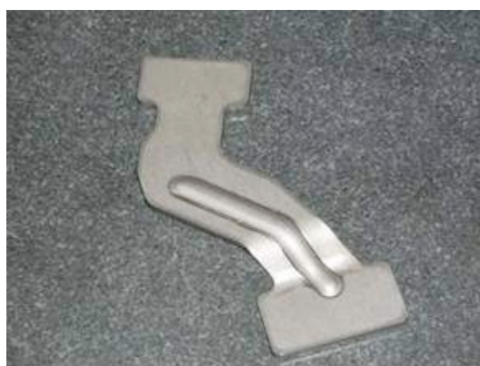
図4-2 寸法精度不具合対策前のデジタル化された不具合成形パネル
