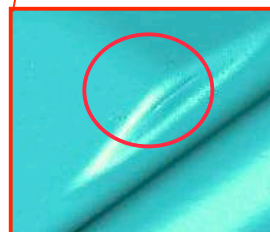
図 2 - 3 われ・しわの不具合がある成形パネル (a)実物 (b)デジタルデータ
