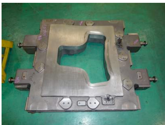
図 2 - 2 われ・しわ不具合対策前のデジタル化された金型形状 (a)上型(b)下型(c)しわ押さえ
