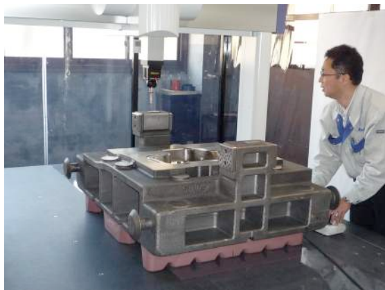
図 2 - 1 3次元測定機による金型形状の測定
