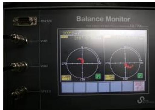
図 35 質量アンバランスのモニタリング
