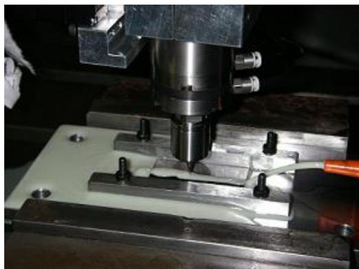
図 43 穴切削加工の様子 (拡大)
