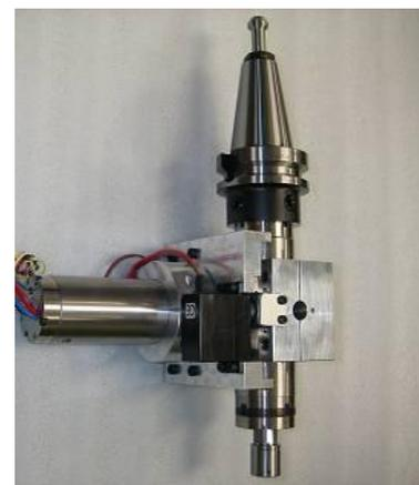
図 36 ドリルユニットの試作機
