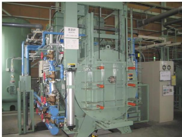
図 2-18 焼入・焼戻実施真空炉
