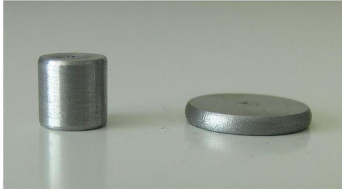
図 2-22 圧縮試験前後試料（左：試験前、右：試験後）
