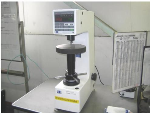
図 2-10 ロックウェル硬さ試験機
