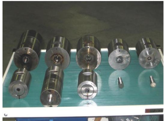
図 2-6 冷間鍛造金型
