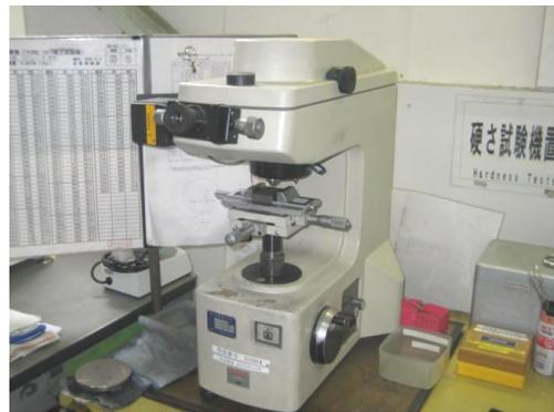
図 2-11 マイクロビッカース硬さ試験機
