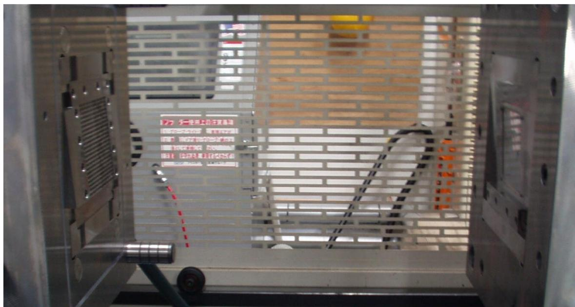
図1-2-2 ハニカム成形試験金型の写真：右は固定側、左は可動側
